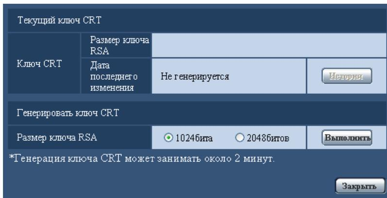
2. Выбирают “1024бита” или “2048битов” в параметре длины CRT для генерирования для “Генерировать ключ CRT” - “Размер ключа RSA”.
