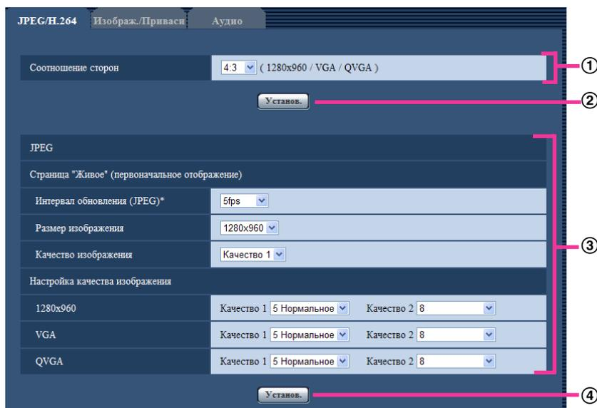
По окончании задания параметров в поле ① щелкают по кнопке [Установ.] (②) под полем (①). Редактированные уставки в поле ① не применяются, если не производится щелчок по кнопке [Установ.] (②) под полем (①). Аналогичным образом щелкают по кнопке [Установ.] (④) под полем ③ по окончании задания параметров в поле ③.
